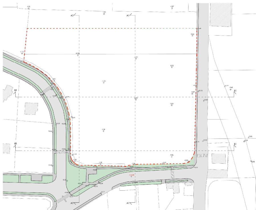
RILIEVO PLANOALTIMETRICO DELL'AREA OGGETTO D'INTERVENTO
